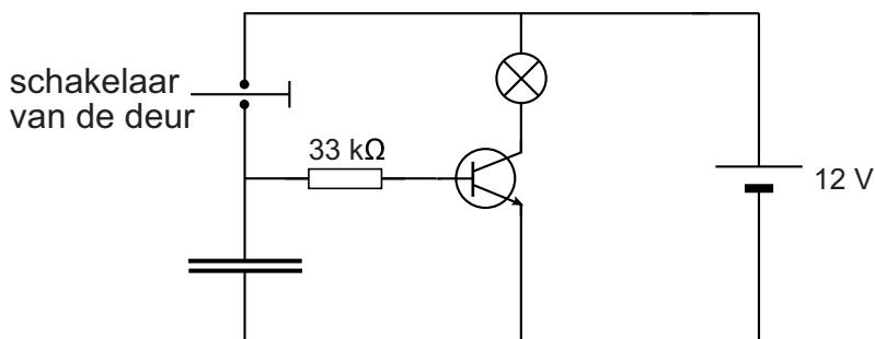
Is de deur open, dan is de schakelaar gesloten. Als je de deur sluit, gaat de schakelaar open.
